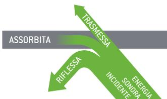
La parte di energia sonora che viene riflessa dipende dalle caratteristiche di assorbimento acustico della superficie, mentre la parte che viene trasmessa dipende dalle caratteristiche di isolamento acustico del sistema.
