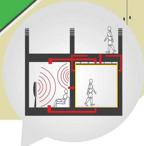
Con l'utilizzo delle speciali lastre dBred ZerodB GIPS si realizzano rivestimenti a controparete o a controsoffitto per la riqualificazione termo-acustica di partizioni tradizionali in laterizio. Sviluppandosi in pochi centimetri risultano particolarmente adatti per ristrutturazioni o per edifici ad alte prestazioni acustiche.
