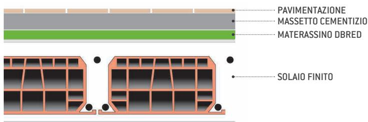
Per sistema a **massetto galleggiante** si intendono massetto di finitura e pavimentazione posati su un materassino anticalpestio, completamente svincolato dal solaio e dalle partizioni verticali. Sarà quindi un sistema libero di vibrare.
