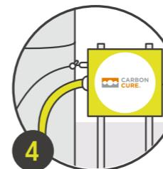
Il sistema di immissione CarbonCure inietta con precisione la CO<sub>2</sub> nella miscela di calcestruzzo.
