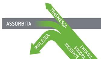
La parte di energia sonora che viene riflessa dipende dalle caratteristiche di assorbimento acustico della superficie, mentre la parte che viene trasmessa dipende dalle caratteristiche di isolamento acustico del sistema.
